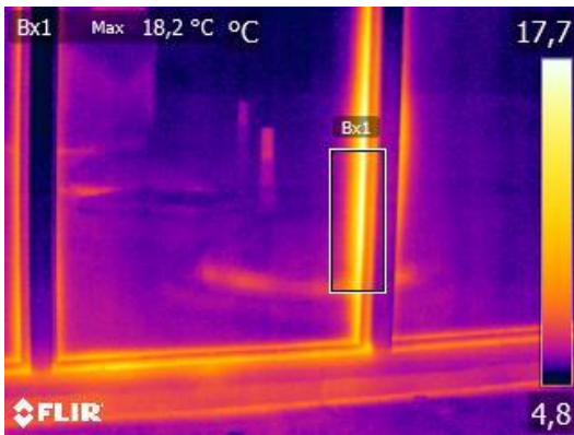
Foto 76, fasad, fönster med lös tätningslist, tydligt luftläckage vid fönsteranslutningar, (3). Flertalet fönster.
