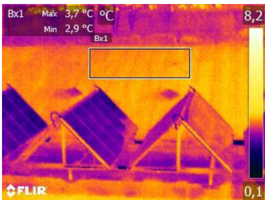
Foto 89, takplan, små temperaturdifferenser, ingen tydlig anmärkning.
