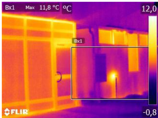
Foto 7, fasad, mindre avvikelser vid genomföring av rör i fasad (1).
