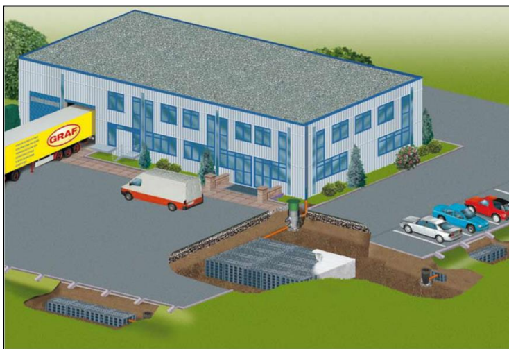
Figur 12. Exempel på utjämningsmagasin bestående av dagvattenkassetter (Uponor, 2009).
